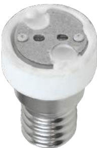
патрон-перехідник керамічний, для галогенних ламп, перехідник E14 - G5.3 розмір, мм : 22*38 навантаження: 230v
