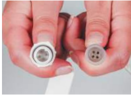
З'єднати вихід виведеної світлодіодної стрічки з відповідним входом підсилювача: виступ на коннекторі стрічки повинен співпасти з поглибленням в коннекторі підсилювача.
