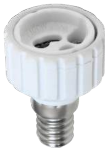
патрон-перехідник керамічний, для галогенних ламп, перехідник E14 - GU10 розмір, мм : 35*53 навантаження: 230v
