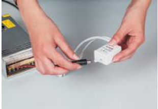
Вставити роз'єм DM111 в коннектор контролера
