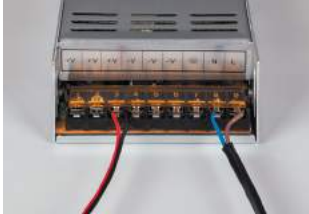
1) Підключити дрiт DM111 до блоку живлення, дотримуючись полярності. 2) Підключити живлення 220V/50Hz до блоку живлення: синій дрiт нейтраль N, коричневий - фаза L
