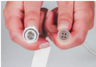
Вставити чотирихвостковий коннектор у відповідний роз'єм стрічки, використовуючи положення «ключів» - виступу на з'єднувачі контролера і «ключів» - поглиблення на з'єднувачі стрічки.
